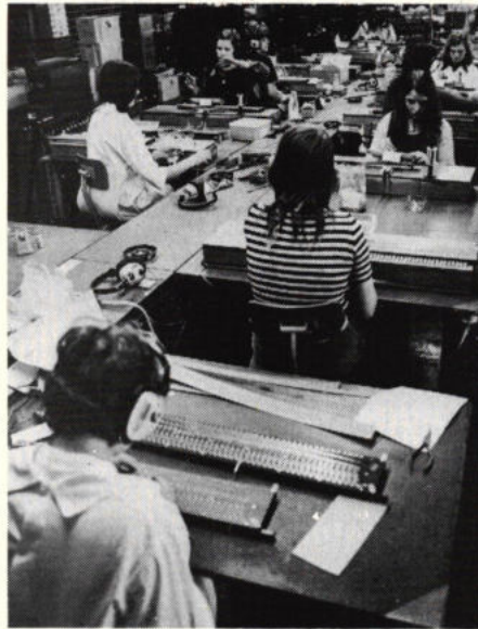
Afb. 8. Een belangrijk gedeelte van het handwerk bestaat uit het monteren van de vergulde toetscontacten. Dit werk moet uiterst nauwkeurig gebeuren omdat veel van de orgelkwaliteit daarvan afhangt.
