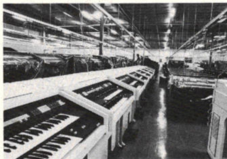
Afb. 12. Als de orgels volledig zijn getest worden ze onderworpen aan een duurproef. Hierbij staat het orgel constant onder spanning. Door deze speciale test wordt de service tot een minimum beperkt.
